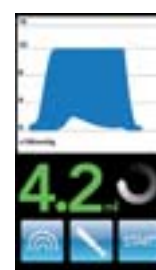
Abb. 2 Durch den hohen Druck wird die Schneider'sche Membran schlagartig von der Fräse weggedrückt
