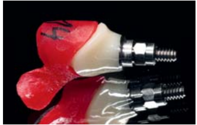
Abb. 8 Auf der Titanbasis verklebte Zirkonoxid-Kappe (TitaniumBase für Xive, Dentsply Implants/Mannheim) mit einem Kunststoffschlüssel zur Überprüfung der Passung
